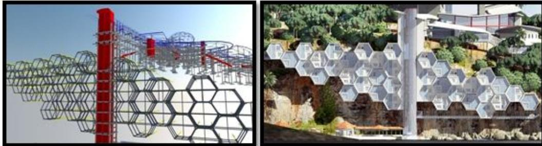
Gambar 6 Sistem struktur unit-unit heksagonal pada tebing.
