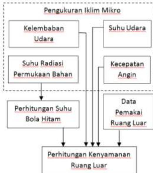
Gambar.1. Diagram alir perhitungan kenyamanan berdasar data pengukuran suhu permukaan bahan
