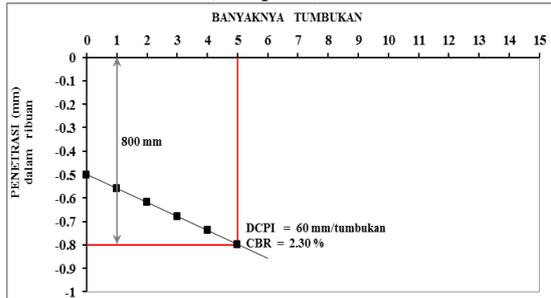
Gambar 15 Grafik Hasil Pengujian DCP pada STA 28+300
