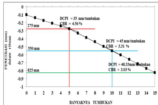
Gambar 17 Grafik Hasil Pengujian DCP pada STA 28+500
