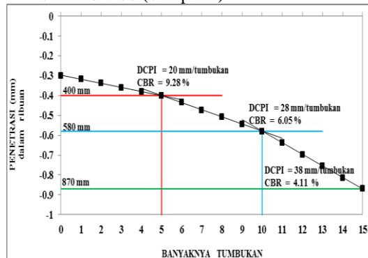
Gambar 14 Grafik Hasil Pengujian DCP pada STA 28+200
