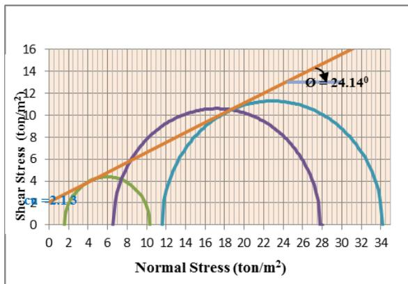
Gambar 10 Lingkaran Mohr Hasil Pengujian Triaksial 2
