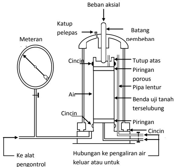
Gambar 3 Alat Pengujian Triaksial (Braja M. Das, 1995)
