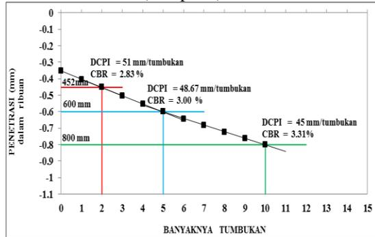
Gambar 18 Grafik Hasil Pengujian DCP pada STA 29+000
