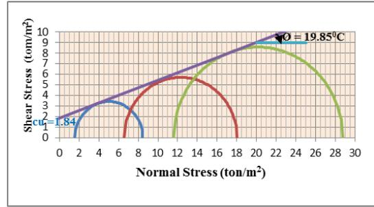
Gambar 8 Lingkaran Mohr Hasil Pengujian Triaksial 1
