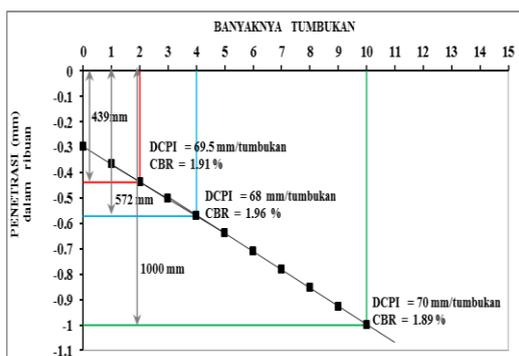
Gambar 16 Grafik Hasil Pengujian DCP pada STA 28+400
