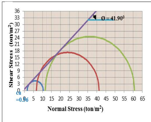
Gambar 12 Lingkaran Mohr Hasil Pengujian Triaksial 3
