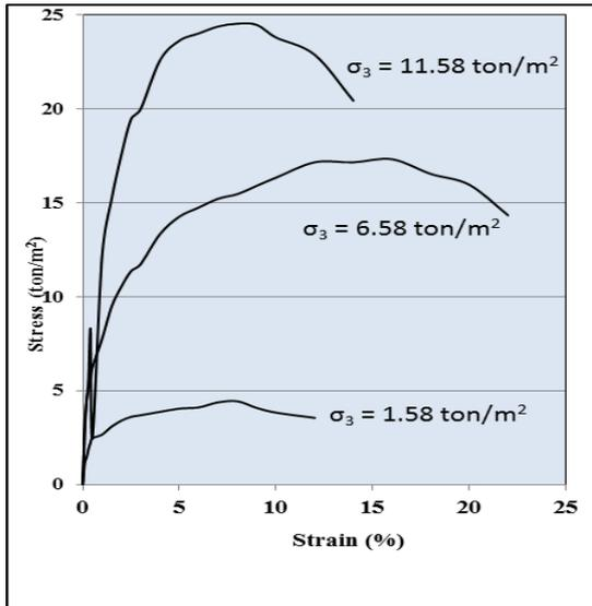
Gambar 11 Grafik Hubungan Stress (tegangan) dan Strain (regangan) pada Pengujian Triaksial 3
