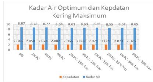
Gambar 8. Grafik gabungan Kepadatan kering maksimum ( \gamma_d ) dan Kadar Air Optimum ( w )
