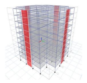
Gambar 4. Model 3-Dimensi Struktur yang Ditinjau.
