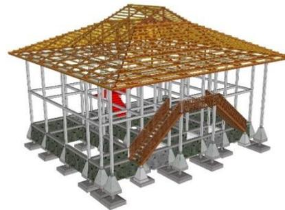
*Gambar 13. Isometri Struktur Bangunan Layanan Informasi*
