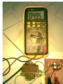
Gambar 11. Pengujian Tegangan Output IC Regukator 7805
