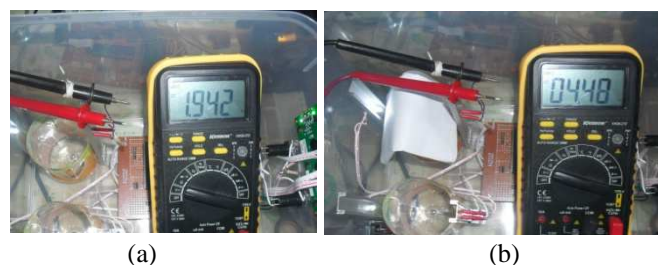
Gambar 14. Pengujian Sensor LDR, gambar (a) Mengenai cahaya. (b) Tidak mengenai Cahaya
