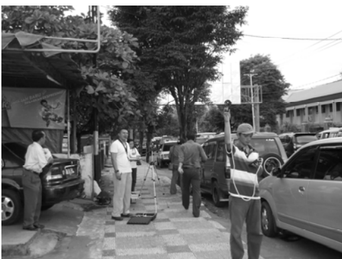
Gambar 3. Pelaksanaan Pengukuran Karakteristik Atmosfir dengan Alat Intelligent Meter
