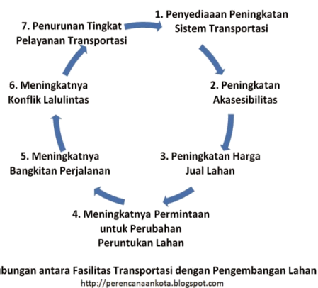
Gambar 2. Hubungan antara fasilitas transportasi dan pengembangan lahan
