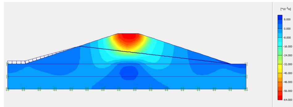
Gambar 8. Deformasi Vertikal Struktur Dam
