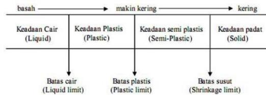
Gambar 2. Batas-Batas Konsistensi Tanah
