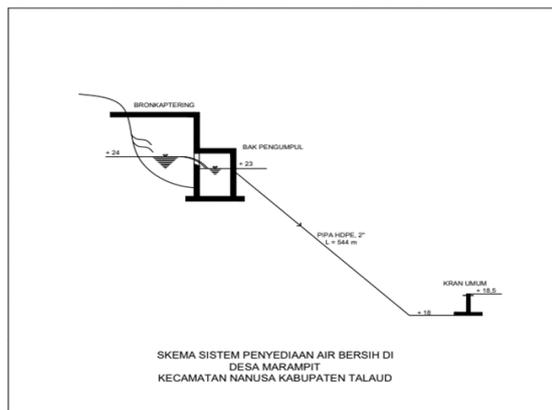
Gambar 3. Skema Sistem Penyediaan Air Bersih
