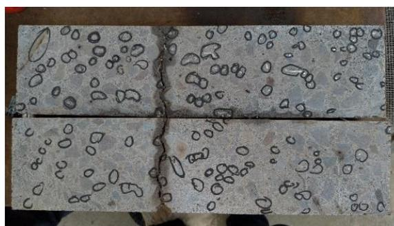
Gambar 18. Penyebaran Kawat Pada Potongan Beton Benda Uji Balok persentase Tambahan Kawat Bendrat 1%
