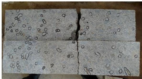
Gambar 17. Penyebaran Kawat Pada Potongan Beton Benda Uji Balok persentase Tambahan Kawat Bendrat 0.5%
