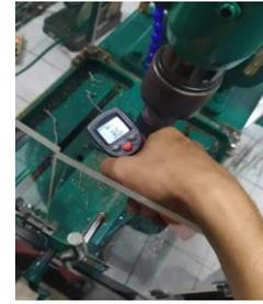
Gambar 4.3 Pengukuran Temperatur Pemotongan
