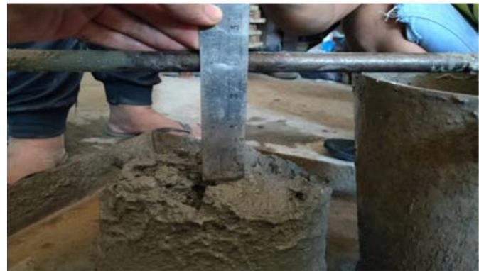
Gambar 2. Contoh Sampel Pengukuran Nilai Slump
