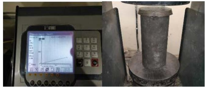
Gambar 5. Contoh Sampel Pengujian Kuat Tekan Beton
