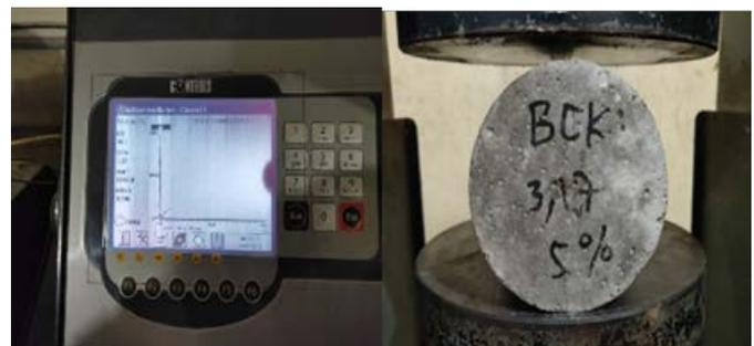
Gambar 8. Contoh Sampel Pengujian Kuat Tarik Belah Beton
