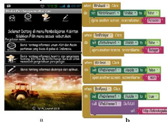
Gambar 3. (a) Tampilan Menu Utama Aplikasi, serta (b) Blocks Source Code dari App Inventor
