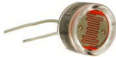
Gambar 4. Bentuk Fisik Sensor LDR
