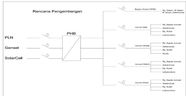
Gambar 10. Diagram Satu Garis energy terbarukan Menggunakan Sistem Solar Cell
