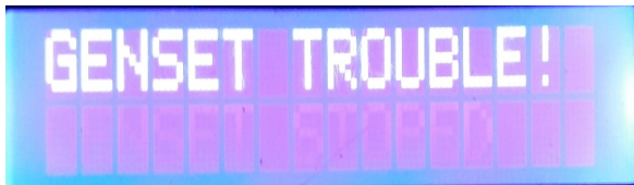
Gambar 25. Tampilan Lcd saat Genset bermasalah
