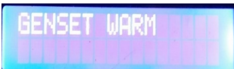
Gambar 19. Tampilan LCD pada saat Pemanasan Genset
