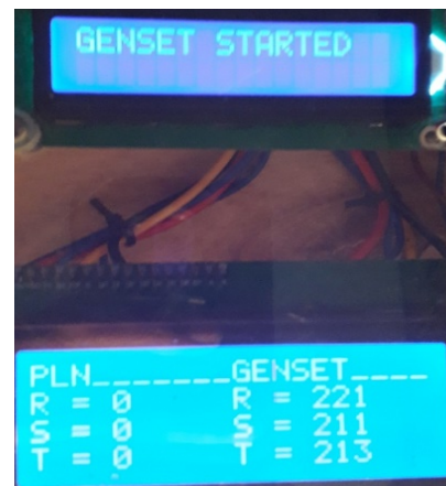
Gambar 20. Tampilan LCD saat Genset Menyuplai Beban
