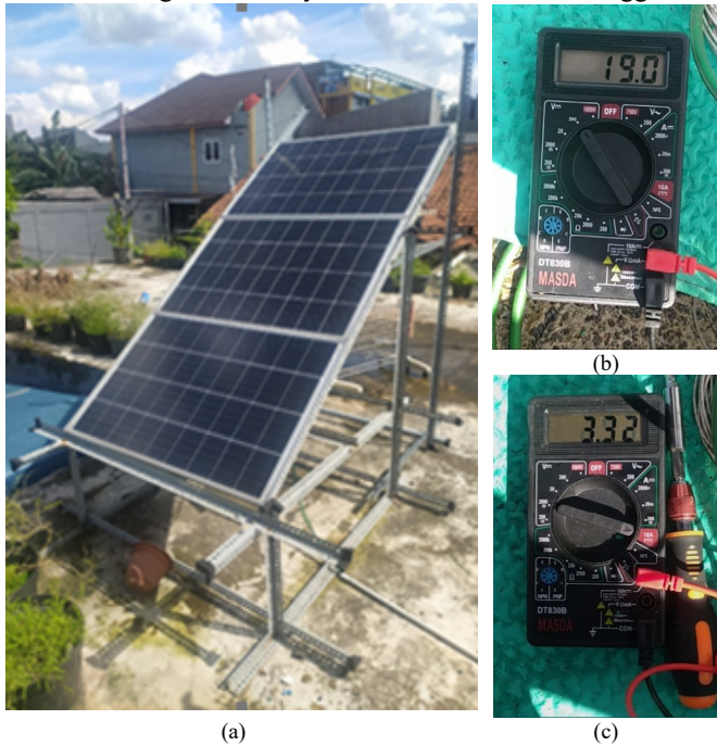
Gambar 5. (a) Panel Surya serta hasil pengukuran, (b) Tegangan pengisian dan (c) Arus pengisian
