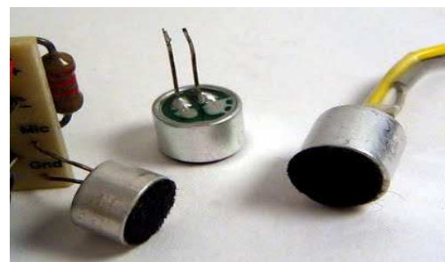
Gambar 4. Bentuk asli Microphone Condenser
