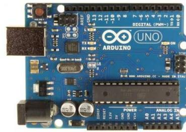
Gambar 8. Board arduino uno
