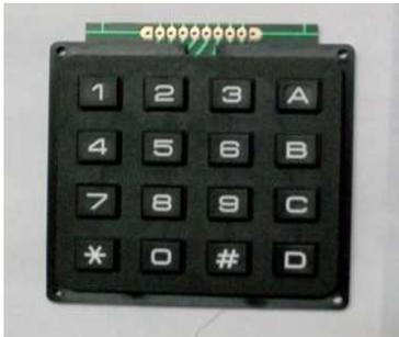
Gambar 3..Bentuk fisik Keypad 4x4
