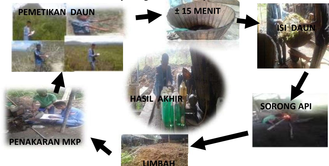
Gambar: Proses Penyulingan Daun Kayu Putih
