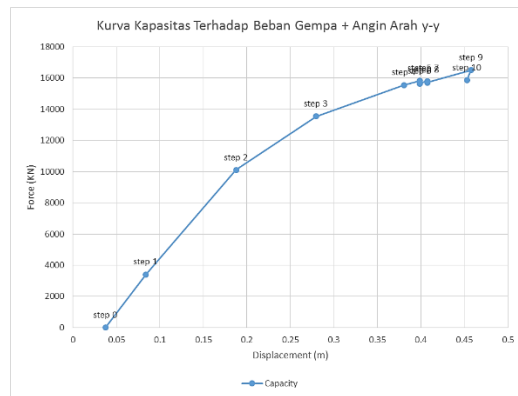
Gambar 19. Grafik Kurva Kapasitas Beban Kombinasi Gempa + Angin Arah y-y
