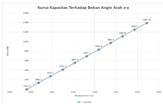
Gambar 13. Kurva Kapasitas Beban Angin Arah x-x
