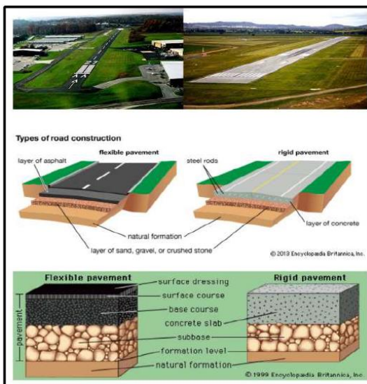
Gambar 3. Perbedaan Rigid Pavement dan Flexibel Pavement
