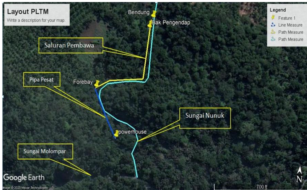
Gambar 8. Layout PLTM di Kawasan Air Terjun Poniki Kecamatan Pasan.
