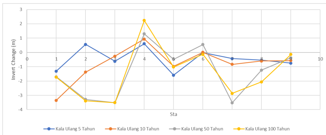
Gambar 21 Grafik Rangkuman Perubahan Dasar Saluran Terhadap Debit Banjir Rencana Q_5, Q_{10}, Q_{50}, Q_{100}
