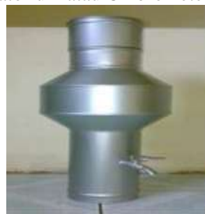
Gambar 1. Alat Penakar Hujan Manual Tipe Observatorium
