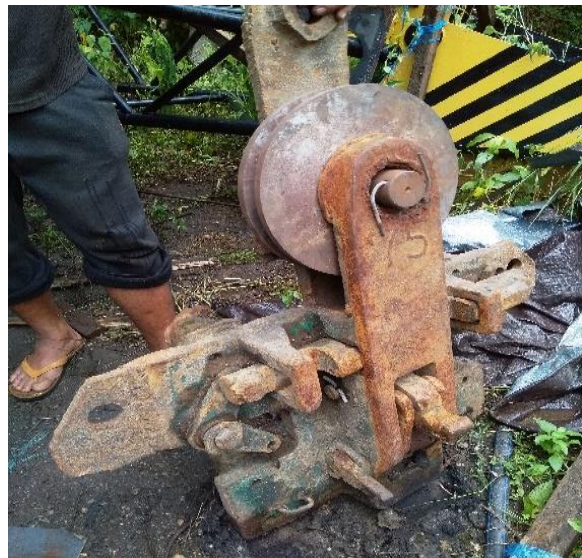
Gambar 21. Pengait Laba-laba ukurannya 1 meter
