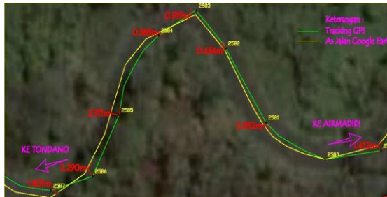
Gambar 8. Mengukur Besar Penyimpangan Rata-Rata Titik Tracking Dengan Bantuan Image Google Earth
