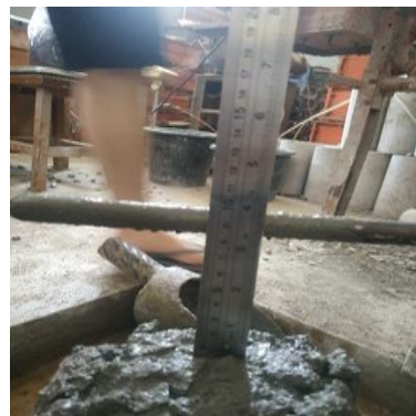
Gambar 6. Contoh Sampel Pengukuran Nilai Slump
