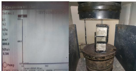
Gambar 11. Contoh Sampel Pengujian Kuat Tarik Langsung Beton Sumber : Dokumentasi Peneliti
