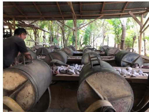
Gambar 6. Tromol Untuk Penggelundungan Biji Emas Sumber: Dokumentasi Pribadi
