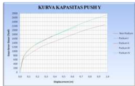
Gambar 12. Kurva Kapasitas akibat Push Y
