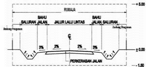
Gambar 1. Potongan melintang jalan untuk jalan perkotaan
