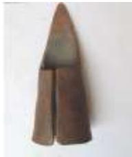
Gambar 5.1 Alat pengupas buah kelapa
