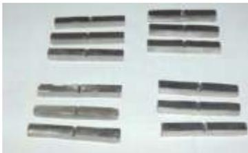
Gambar 5.2 Spesimen Uji Impact Bahan Dasar Pegas Kendaraan
