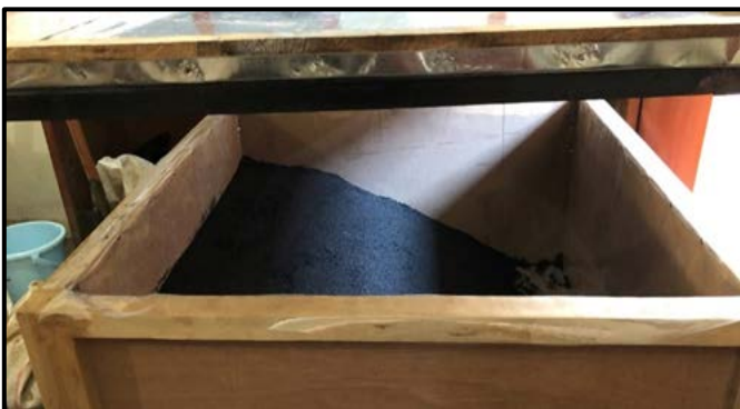
Gambar 2. Proses Pemodelan Lereng Dalam Box
