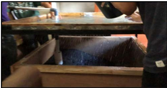
Gambar 4. Hujan Buatan Pada Pemodelan Tes Dalam Box
