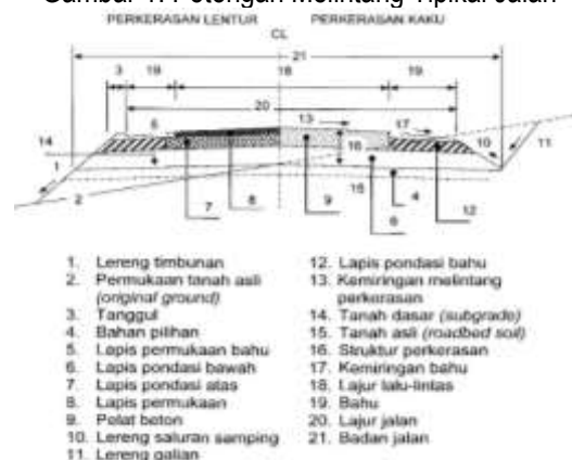
Gambar 1. Potongan Melintang Tipikal Jalan
