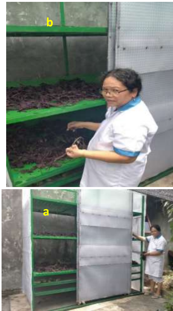
Gambar 7. Bahan baku obat Mayana sudah ditiriskan pada rak pengeringan paling bawah sampai air semuanya mengering (a) kemudian siap untuk dikeringkan langsung dibagian paling atas dan sudah kering setelah 2 hari (b)
