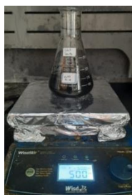
Gambar 2. Proses aktivasi KTJ menjadi karbon aktif menggunakan aktivator di atas hotplate stirrer
