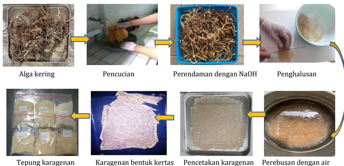
Gambar 1. Tahapan proses pembuatan karagenan dari Kappaphycus alvarezii .
