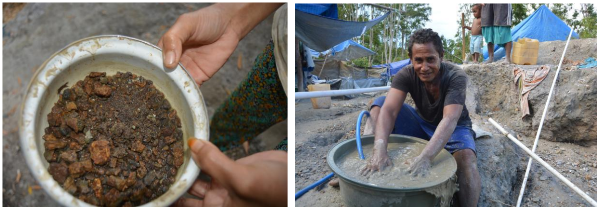
Gambar 2. Proses ekstraksi batuan sinabar dan batuan sinabar yang diperoleh
