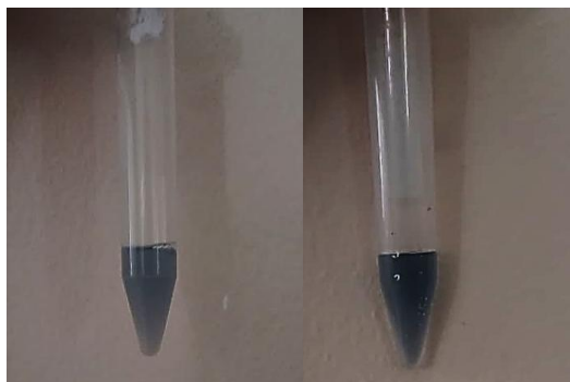
Gambar 4. Hasil pengujian kualitatif limbah cair dalam desinfektan dan pembersih lantai dengan pereaksi \text{FeCl}_3 dan \text{Na}_2\text{CO}_3
