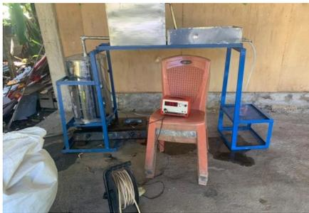
Gambar 1. Alat Pembuatan Minyak Daun Cengkeh Skala Industri Kecil
