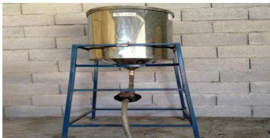
Gambar 4. Mesin Penyaringan Minyak
