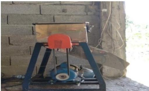
Gambar 1. Mesin Pamarut Kelapa
