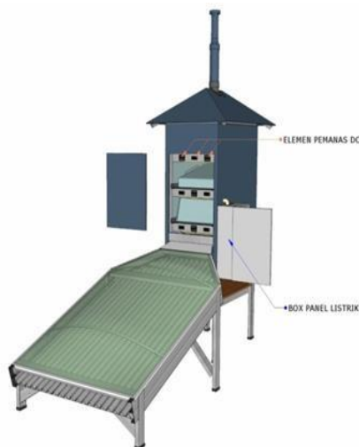
Gambar Penempatan Elemen Pemanas Pada Alat Pengeringan
