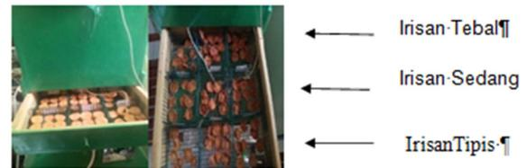
Gambar. 5. Posisi Sampel irisan biji Pinang dalam alat pengering
