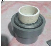
Gambar 6. *Bearing* Dengan Dop Pipa
