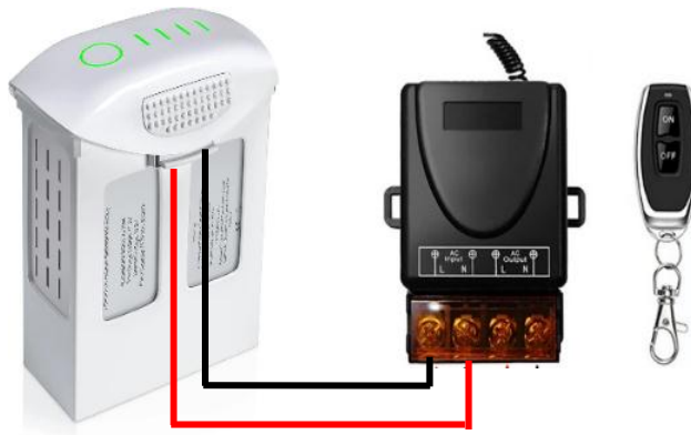
Gambar 2. Rangkaian antara Baterai Drone dan Relay Switch Remote Control
