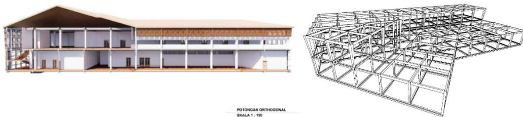
Gambar 9 Potongan Orthogonal & Isometri Struktur Bangunan Utama
